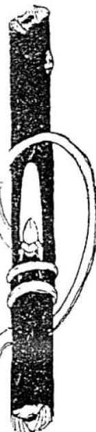
T-řez a umístění očka (v době mízy)
